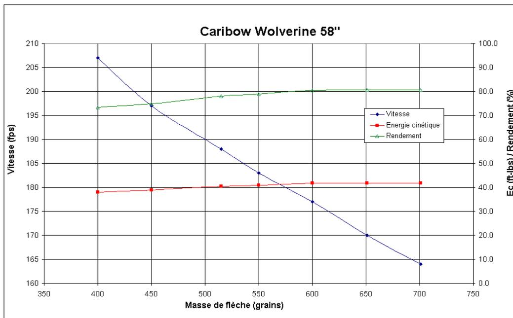
Pour effectuer des comparaisons entre arcs de force différente, il faut se ramener à une référence commune, on va donc diviser la masse de la flèche par la force de l'arc à l'allonge de référence (généralement 28"), on obtient alors les courbes suivantes (les abscisses sont maintenant en grains par livre)
