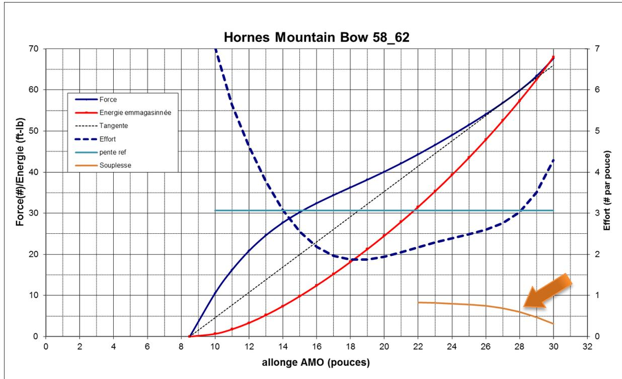
Ce coefficient est déterminé à partir du relevé de force et du calcul de l'effort, il se lit sur l'échelle de droite du graphe. Dans l'exemple ci-dessus, la souplesse est de 0.6 à 28'' d'allonge.
