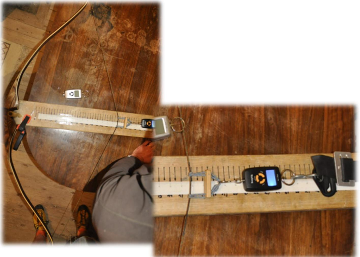
On obtient alors la courbe de force en fonction de l'allonge (trait plein bleu) qui va nous permettre de calculer l'énergie emmagasinée par l'arc. Celle-ci correspond à l'aire (surface) sous la courbe de force, représenté en grisé sur la figure suivante (calcul d'intégrale par la méthode des trapèzes sous Excel).
