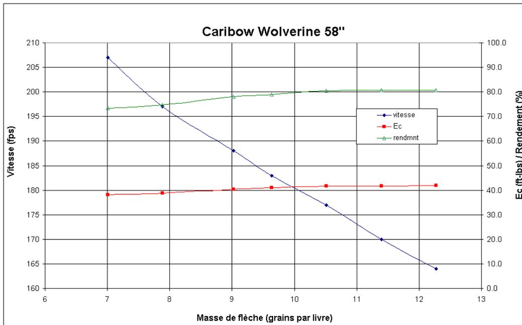
Pour cet arc, à 10 grains par livre et 28'' d'allonge, la vitesse de flèche est de 181 pieds par seconde, l'énergie cinétique est de 42 pied-livre. Sur la première figure on mesure une énergie emmagasinée de 52 pied-livre à 28'' d'allonge, on aura donc un rendement de  $42/52 \cdot 100 = 80.8\%$ .
